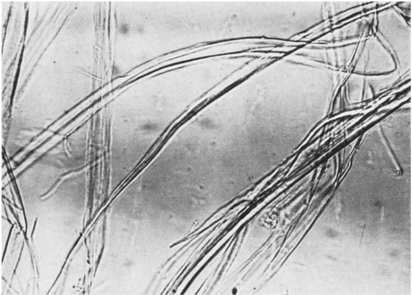
Kupferseide 120 den. 700-fach vergrößert, mit Enzym behandelt.
